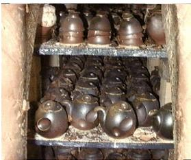
La primera cámara de cocción también se carga con placas y puntales que se disponen a lo largo de toda la cámara manteniendo un separación con el suelo y la bóveda. En la segunda cámara de cocción no hay sitio para poner placas y las piezas son amontonadas unas sobre otras, hasta llenar dos tercios de la cámara.
