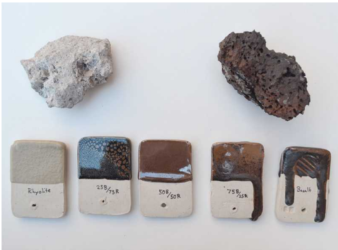
Riolita y basalto y vidriados obtenidos por mezclas de ambos
